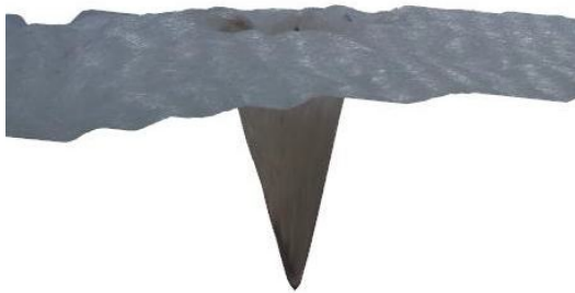
Figura 4. Immagine al SEM e profilo del foro effettuato su un dente.
