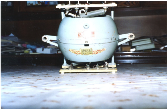
Figura 4 - Foto della cosiddetta "pentola", un generatore a radiofrequenza di potenza progettato e costruito da Nello Carrara nel periodo bellico, con un funzionamento equivalente ad un klystron reflex. Se ne conserva un solo esemplare presso il Museo della Scienza e della Tecnologia "di Milano.
